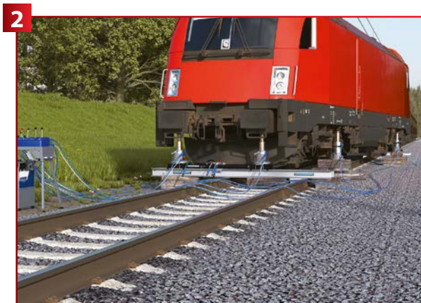
Четыре цилиндра на двух мостовых балках несут нагрузку
