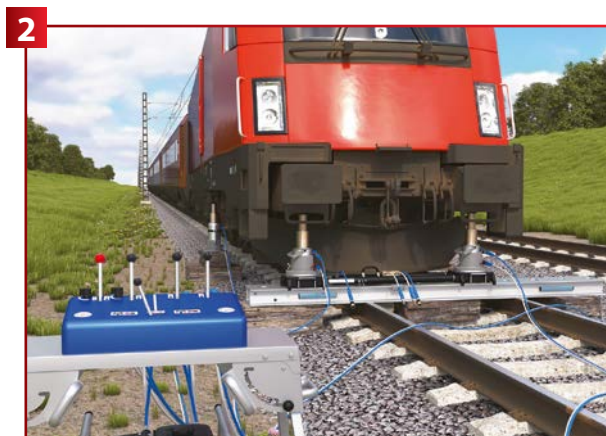
Два цилиндра на мостовой балке несут нагрузку
