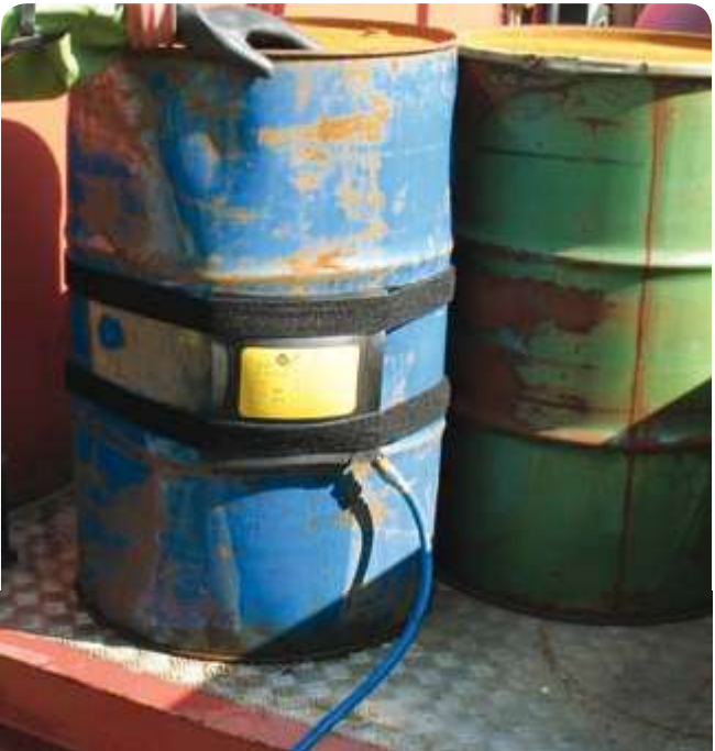
Уплотняющие подушки ликвидируют утечку из бочек.
