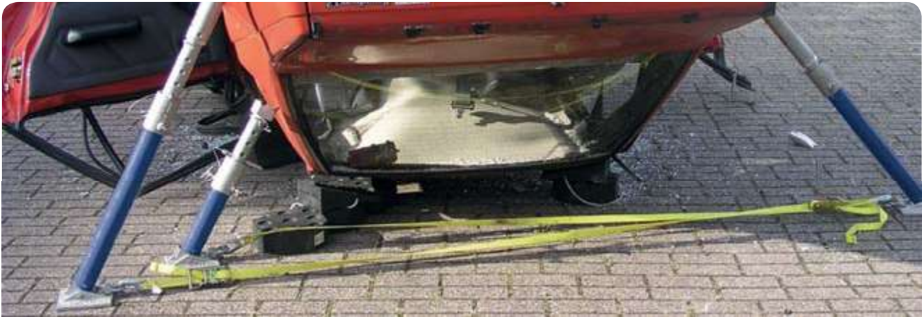
Стабилизация автомобиля опорами ART-Lite.
