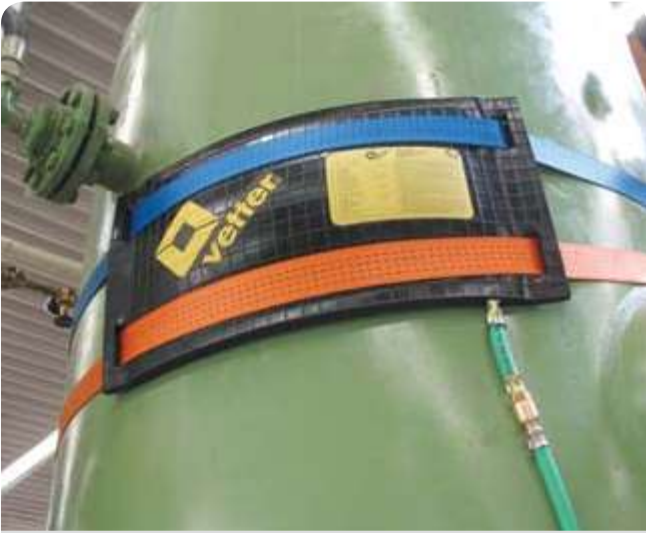
Уплотняющая подушка высокого давления (12 бар)
