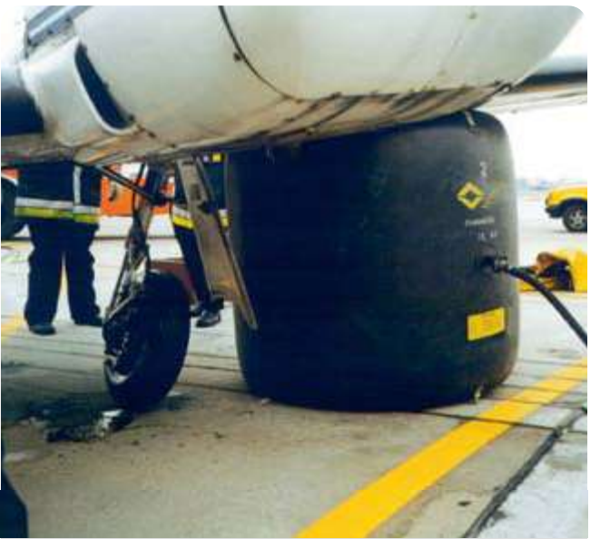
Аккуратное поднятие тонкостенных конструкций.
